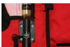
**J** Plaats nu uw nieuw CO<sub>2</sub>-patroon. Draai het aan tot u geen Schroefdraad meer ziet. Schroef het niet te vast. Het patroon moet bijna aansluiten op het plastic van het activeringssysteem. Zit het patroon niet vast genoeg, dan wordt het onvoldoende
