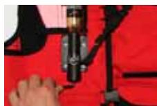
**I** Die endkappe muss festgezogen werden bis kein gewinde mehr sichtbar ist und die kappe sich nicht mehr weiter drehen lässt.
