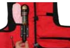
**C** Skruva loss locket och avlägsna fjädern.
